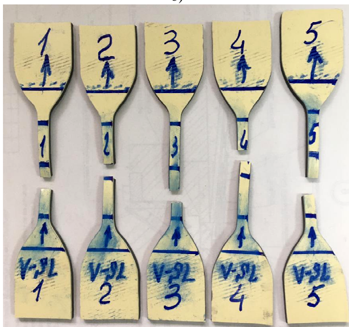
Рисунок 2 – Испытанные образцы рулонного гидроизоляционного полимерного материала LOGICBASE V-SL по определению его деформативно-прочностных показателей вдоль рулона (а) и поперек рулона (б)
