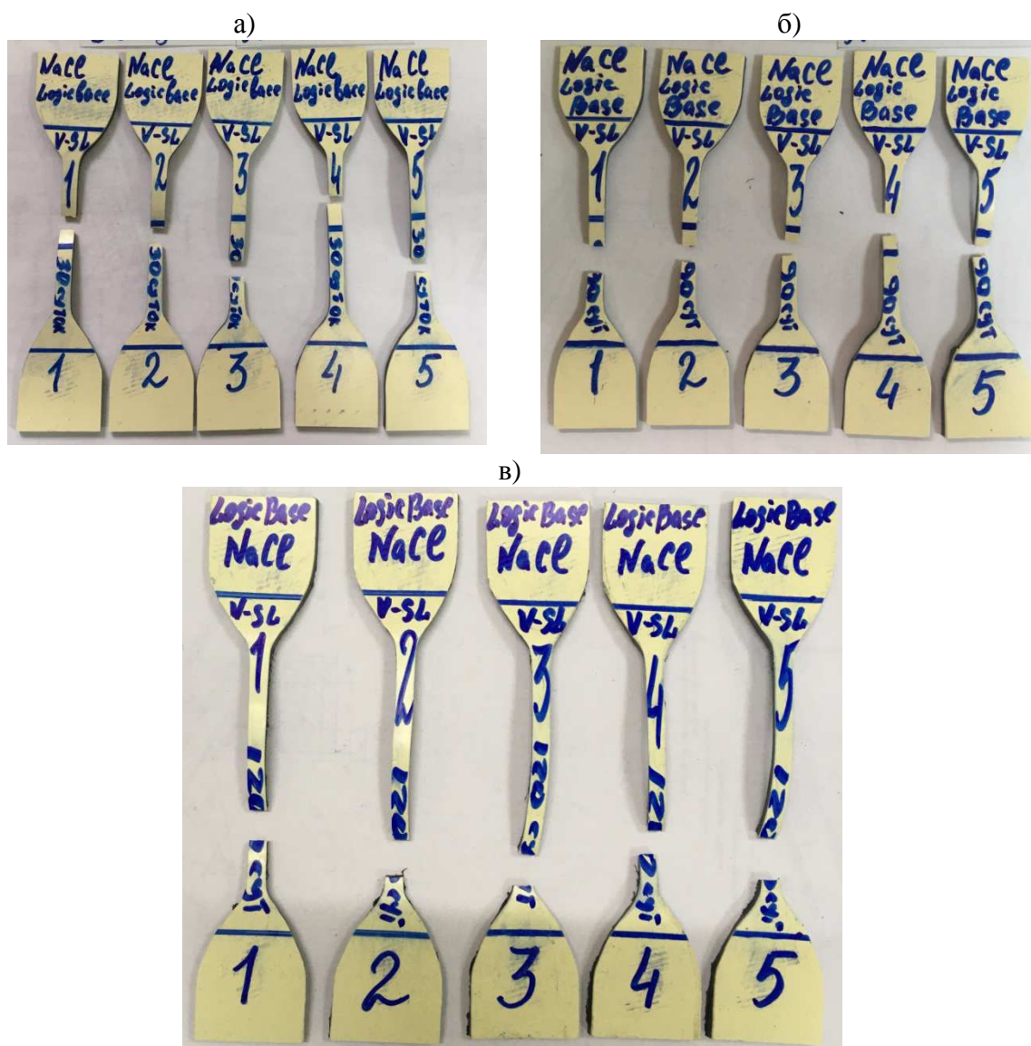
Рисунок 4 – Испытанные образцы рулонного гидроизоляционного полимерного материала LOGICBASE V-SL по определению его деформативно-прочностных показателей после воздействия на него NaCl (насыщенный раствор) в течение 30 (а), 90 (б) и 120 (в) суток
